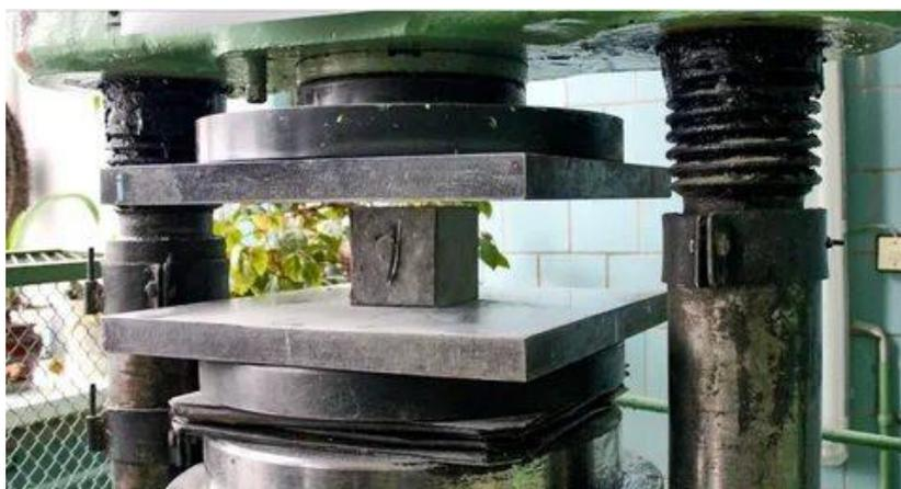
Рисунок 24 - Общий вид пресса для испытаний бетона на сжатие
