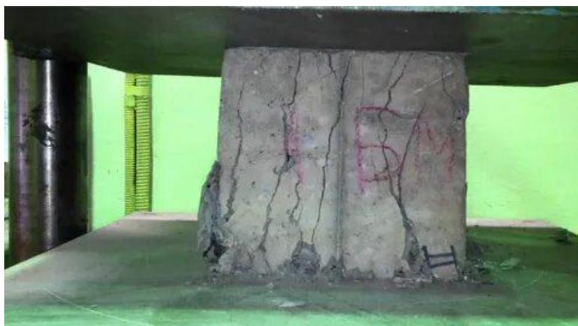
Рисунок 25 - Процесс разрушения куба бетона при испытании
